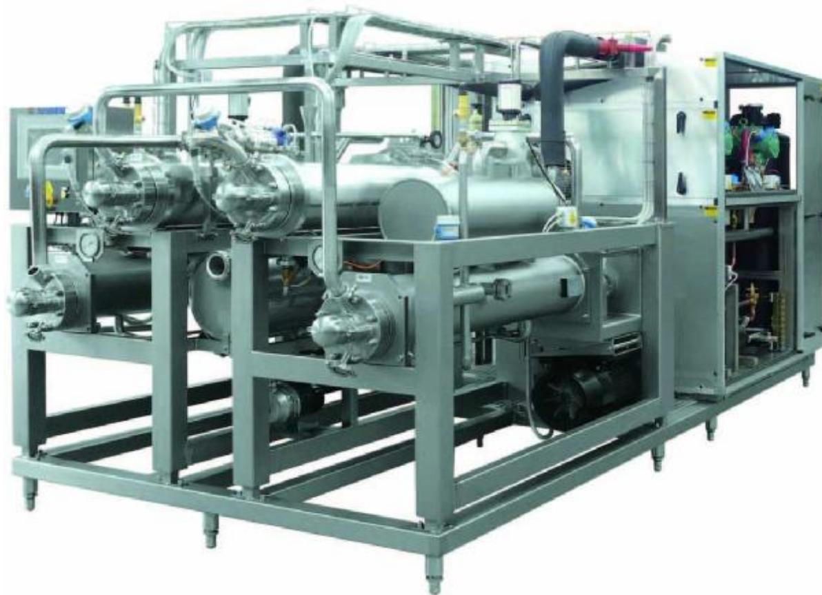
Система кристаллизации SOREN с холодильной системой на Фреоне (Производительность от 100 кг/час до 5.000 кг/час)
